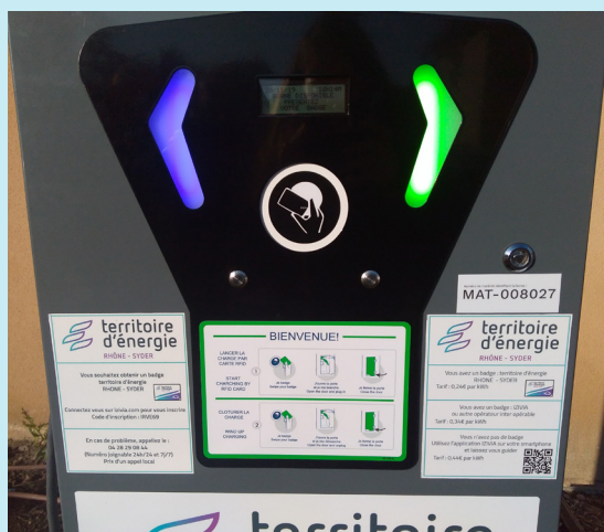
Signification des couleurs des flèches : Bleu : en charge ; Vert : branchement disponible ; Rouge : défaut
